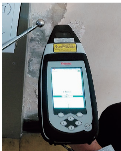
アスベストアナライザーを使用した現場調査
